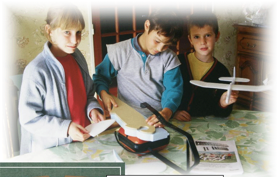
Découpe d'un fuselage à l'aide d'un gabarit et d'une scie vibrante
