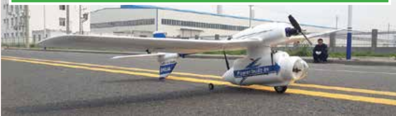
Ce jouet chinois est l'archétype du drone de surveillance en altitude. Pour un prix dérisoire il survole l'objectif pendant plus d'une heure en toute discrétion. Contrairement à un multicoptère il ne peut pas voler par tous les temps, reste assez encombrant et ne peut pas évoluer près du sol.
