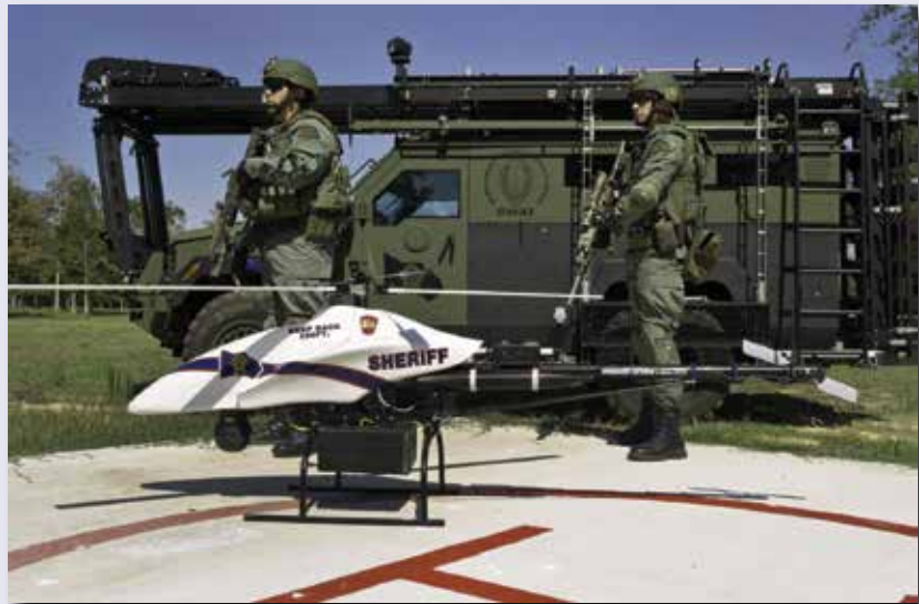
Ici c'est un hélicoptère à pas collectif qui sert de drone pour la police américaine. Ce type d'engin est très performant mais plus coûteux, plus dangereux et moins polyvalent qu'un multicoptère moderne.
