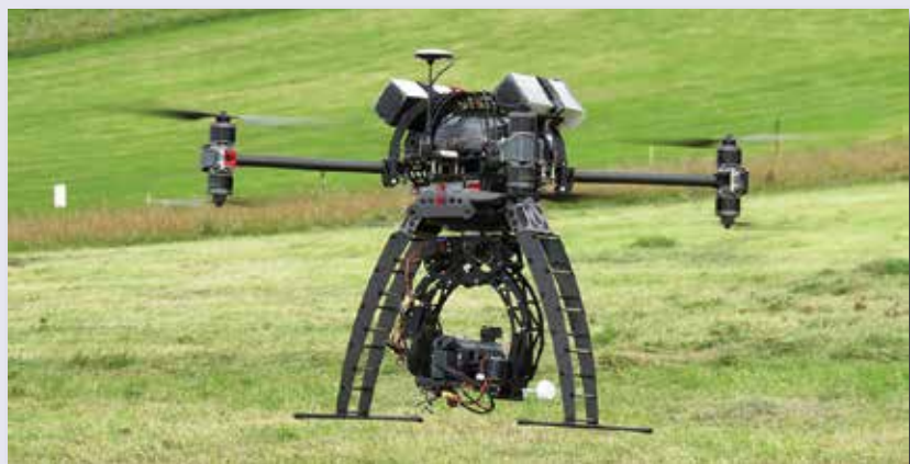
Ce drone haut de gamme est muni de deux moteurs par bras ce qui permet de doubler la puissance sans changer la taille de l'engin. Le train d'atterrissage est rétractable afin de dégager le champ de vision de la caméra embarquée. Pour un appareil de ce type il faut compter un budget de plusieurs milliers d'euros
