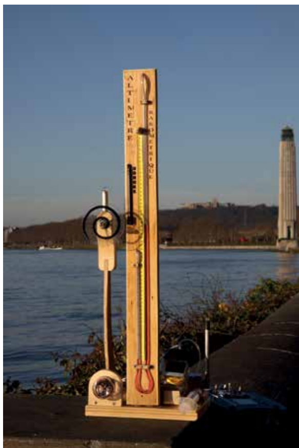
Ci-dessus, l'appareil d'étalonnage des contrôleurs altimétriques imposés pour certaines disciplines du SAM
