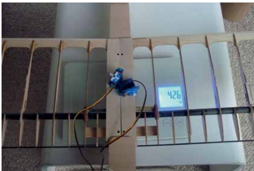
Le gros œuvre équipé du RESolution sur la balance, mais on sait qu'il faudra du lest dans le nez...
