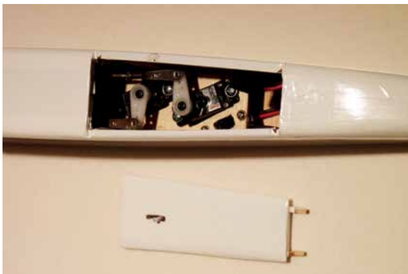
Une petite platine en multiplex adaptée au nez reçoit les servos et un interrupteur bien pratique. La batterie et le lest ont trouvé place dans le nez.
