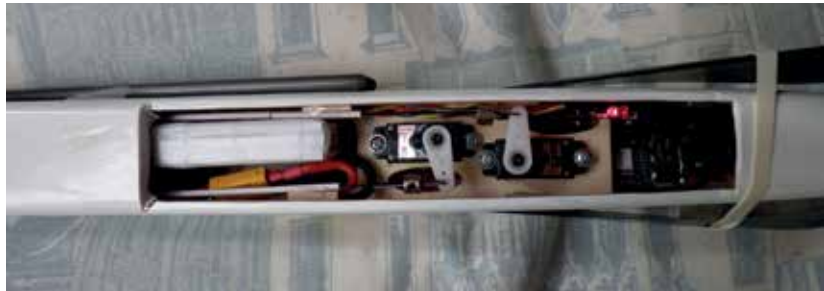
Ci-dessus, l'équipement de l'e-AndREaS est positionné dans le gros oeuvre; ci-dessous l'état terminé, batterie de propulsion branchée. La LED fait partie de l'altimètre.
