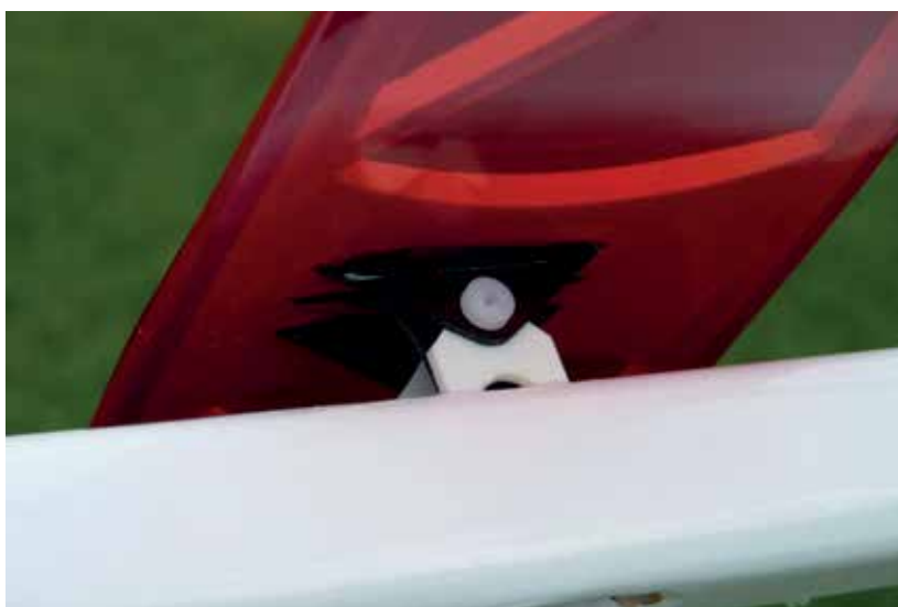
Le montage du stabilo : quelques pièces en composite et une vis nylon 3 mm
