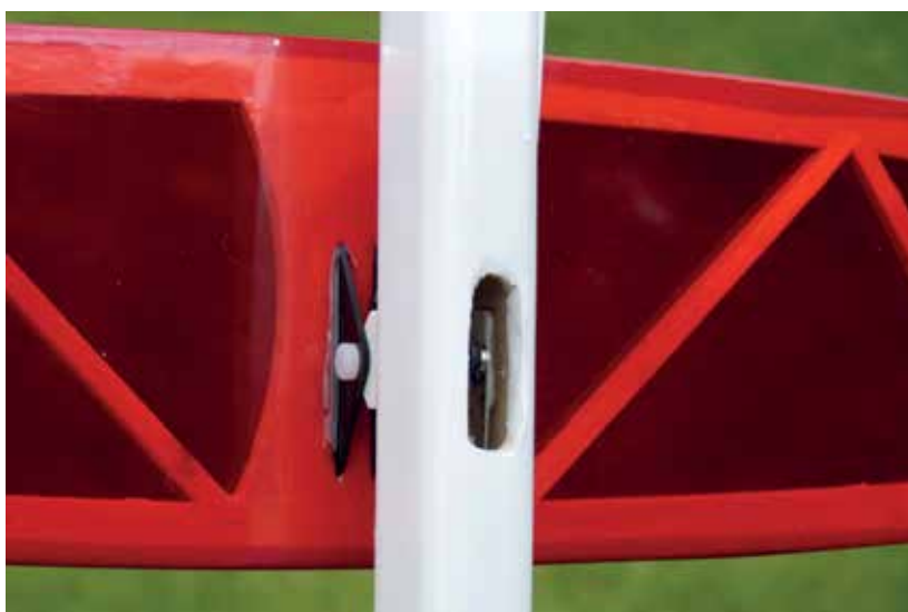
La commande du stab : une chape sur la tringle CAP 1 mm en prise sur la pièce en composite centrale fixée dans la structure
