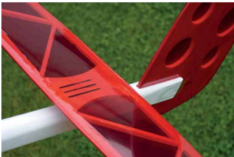
Trois pièces en composite pour fixer et commander le stab. La centrale se prolonge pour recevoir la chape de commande
