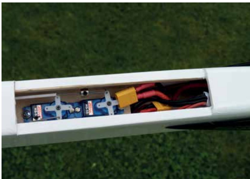
La batterie 3S 550 mAh est en place devant la platine des servos d'empennages dans le nez "court" du PicaRES. Le CG est à sa place!
