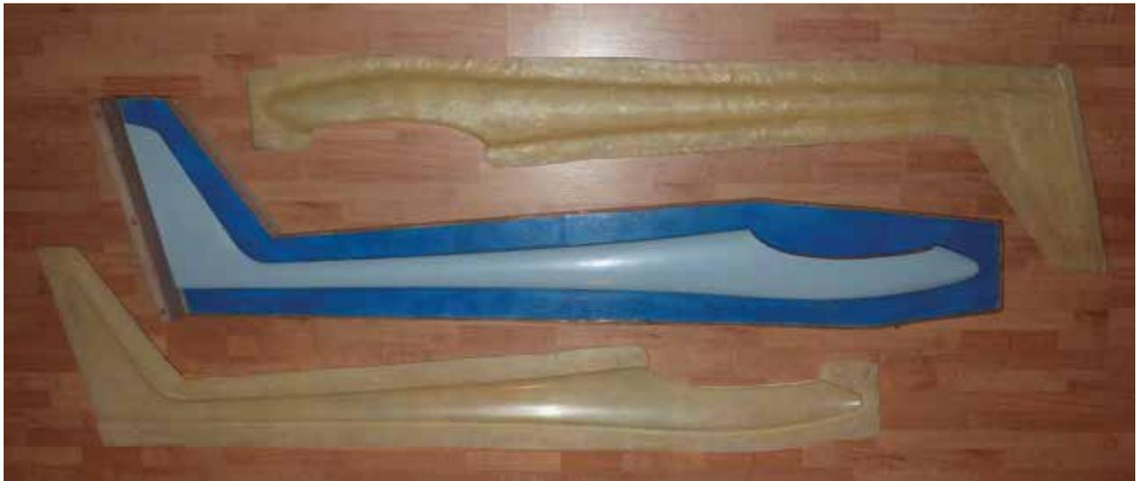
démoulage, la partie verrière du modèle est retirée, le fond est passé au bouche pore et peint et l'arête remise en forme. Un chantier de séparation est alors fait en contreplaqué épousant le plan de symétrie du modèle.
