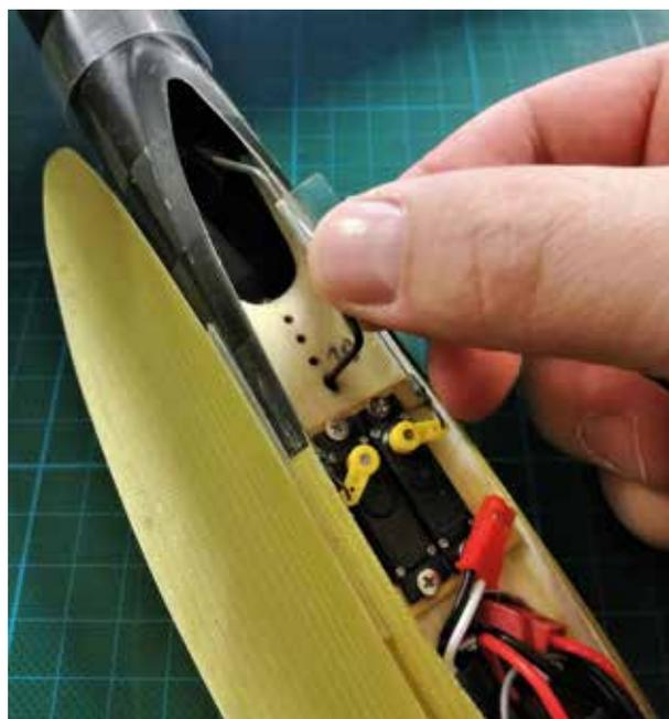
J'utilise des Graupner DES427BB pour actionner les gouvernes d'ailerons. Ces ailerons servent aussi d'aérofreins car ils peuvent débattre jusqu'à 90° vers le bas. Les commandes d'ailerons sortent à l'extrado afin de réduire la traînée. Le récepteur doit aussi être de taille réduite (j'utilise le 6106HFC de chez Futaba).
