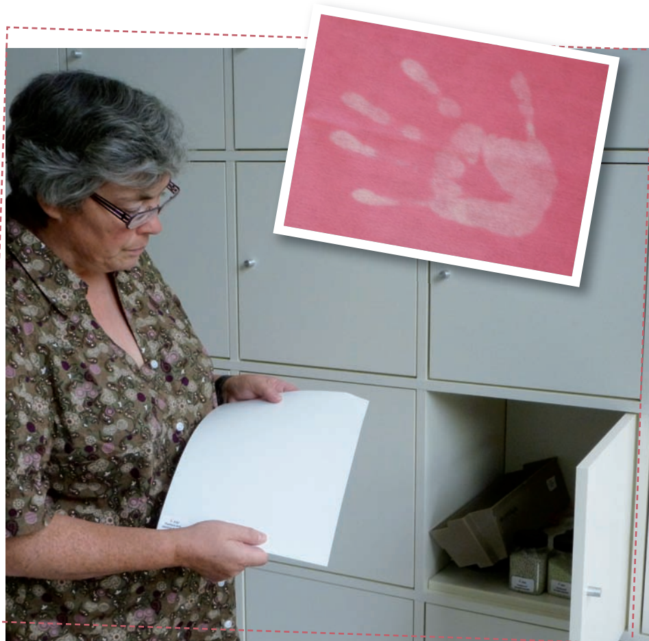
Ce tissu change de couleur suivant la température
