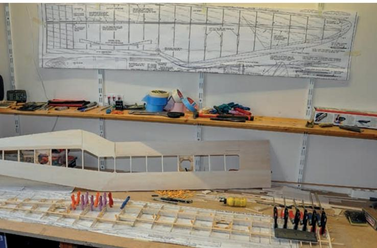
La première aile terminée, la seconde vous attend. La pose des renforts en CTP au niveau de la clé d'aile et de la jointure de la partie en flèche de l'aile doit être soignée pour assurer la résistance des assemblages.
