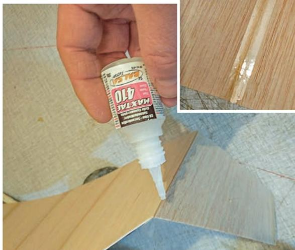
Le coffrage d'une des ailes est prêt à être posé sur le noyau.
