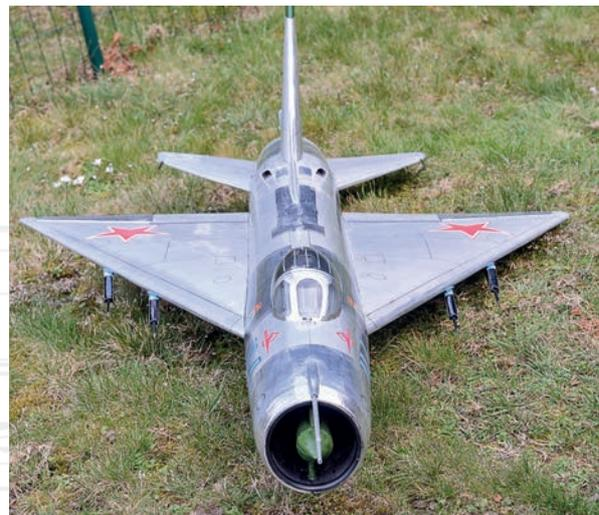
Les deux prises d'air sur le fuselage sont faites de bouts de balsa. J'ai omis celles situées en-dessous car elles risqueraient trop d'être arrachées.
