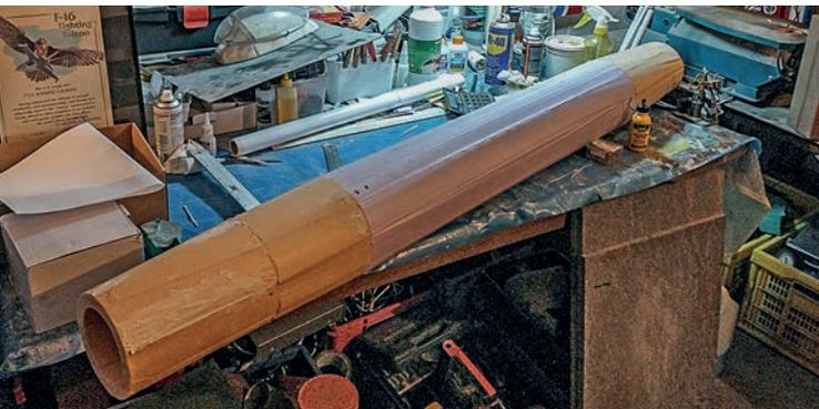
Première découpe du "tuyau". Les formes sont simples, les irrégularités seront rebouchées à l'enduit Polyfilla super-léger (le pot semble vide quand on le soupèse) puis la surface poncée.
