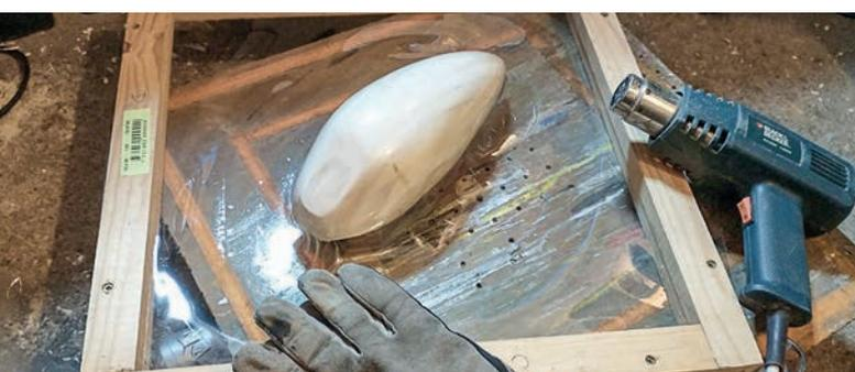
La verrière terminée. Pour la démouler plus facilement, elle est découpée au niveau de l'arceau. La décoration en alu autocollant permet de la reconstituer. L'alu autocollant est posé puis mis en forme en frottant avec le dos d'une petite cuillère.
