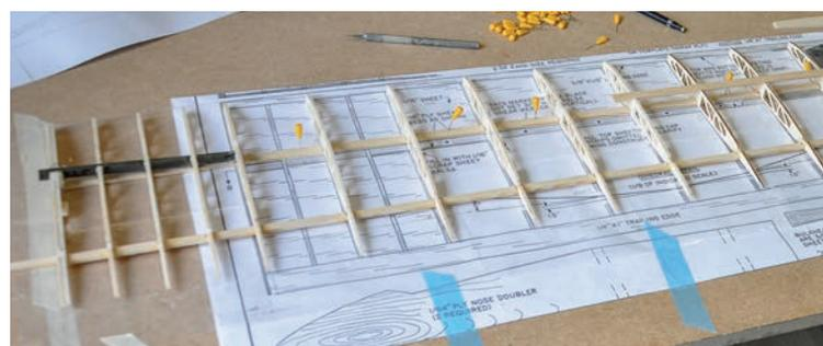
*La pose du câblage, sur la nervure d'emplanture la prise MPX et au centre, le cadre de fixation du servo du volet.*
