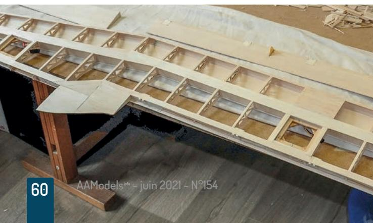
Le coffrage de l'aile est partiel. La section formée par l'emplacement du fourreau de la clé d'aile est entièrement coffrée du bord d'attaque au bord de fuite, intrados et extrados. Il en est de même en ce qui concerne le saumon de l'aile.
