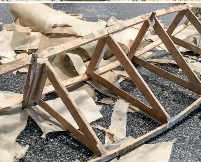
Une structure de fuselage composée de cadres triangulaires, une technique courante à l'époque de sa conception.
