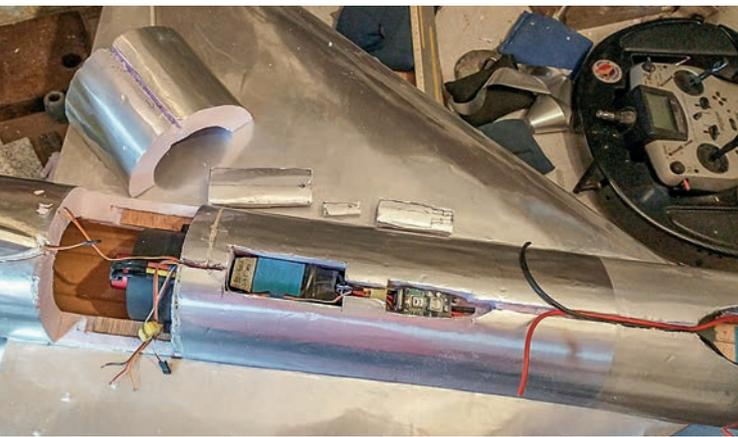
Comme l'accu ne peut pas être déplacé, c'est la position de la turbine qui permet de régler le centre de gravité. Il faut donc mettre tous les éléments à leur place pour mesurer. De gauche à droite, on voit la turbine, le contrôleur, l'UBEC pour l'alimentation de la radio et le gros câble noir et rouge venant de l'accu. Le radiateur du contrôleur dépasse dans la veine d'air, juste devant la turbine.
