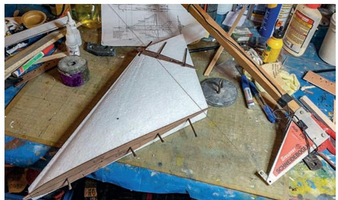
Découpe de la dérive à l'aide d'un grand arc acheté dans les années '80 chez Graupner. Les dépouilles servent lors du coffrage, pour bien plaquer le bois sur le profil. Le gabarit en bois est simplement maintenu par des clous piqués dans la mousse.
