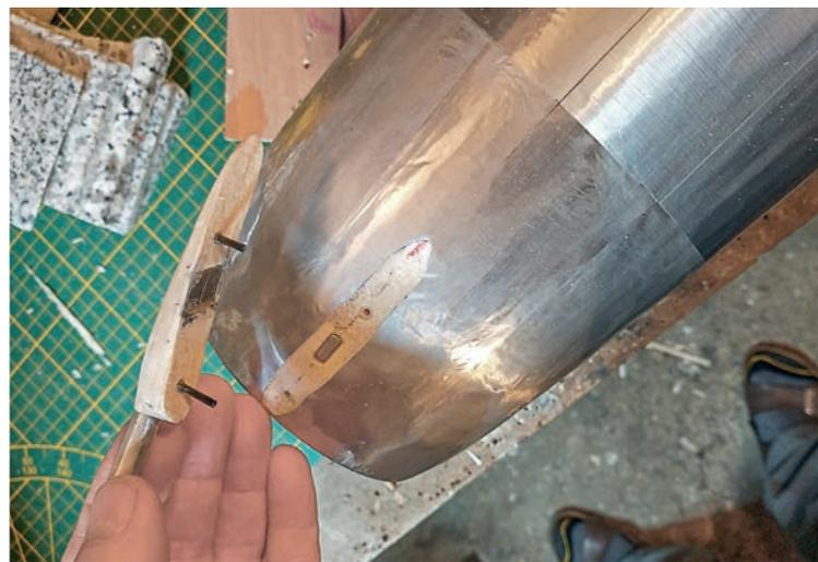
Le tube de Pitot est amovible, maintenu par deux tiges de carbone fichées dans des gaines en plastique collées dans le fuselage. Un aimant au néodyme attire un bout de lame de cutter collé sur le carénage.
