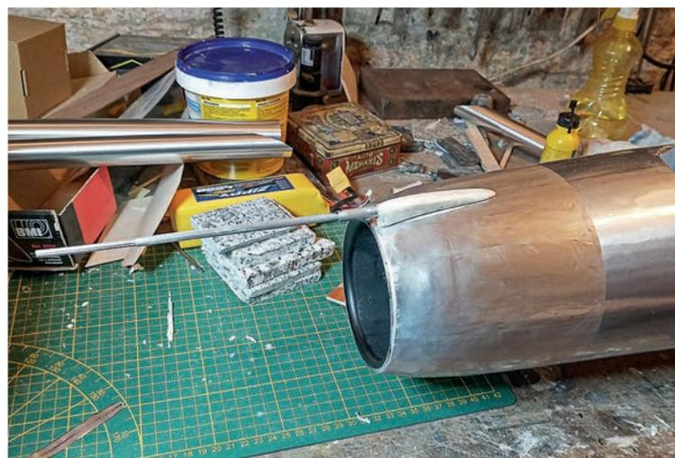
Le reste du Pitot est fait de deux tubes d'aluminium terminés par un bout de gaine de commande Sullivan. Le plastique est peint en argenté. Notez que contrairement au réel, l'entrée d'air est arrondie pour un meilleur rendement de la turbine. L'anneau noir était d'ailleurs fourni avec la turbine.
