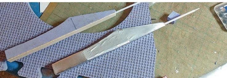
Les pylônes sont découpés dans un tapis de sol en mousse incassable; ils sont très exposés, c'est préférable à une mousse plus cassante. Les gaines de commande en plastique figurent les masses d'équilibrage montées à l'avant des pylônes. Une latte de balsa 2 mm collée sur toute la longueur rigidifie l'ensemble. Les pylônes sont maintenus sur l'aile à l'aide de velcro autocollant, de façon à s'arracher en cas d'impact.
