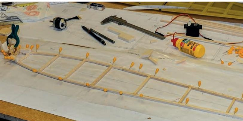
Une structure toute en lattes et longerons, composée de cadres triangulaires font le charme indéniable de ce fuselage.
