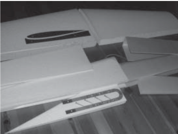
Photo 1 - les gabarits de découpe et les éléments découpés
