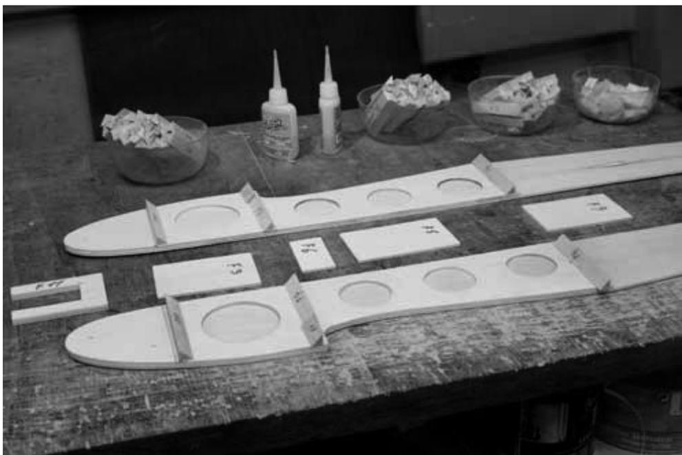
L'assemblage du fuselage - quelques renforts ajourés assurent solidité et légèreté
