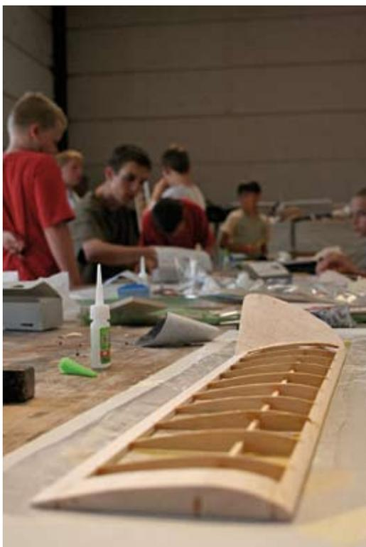
un plan RCM d'un petit planeur RC 2 axes, le « Dune ». Décoder un plan, identifier les pièces, les épaisseurs, les matériaux, tracer puis couper le balsa, affiner les nervures, coller avec précaution, ajuster, poncer... Non, la construction n'est pas morte ! La preuve avec l'attention et la persévérance dont ont témoigné ces débutants une semaine durant, un signe qui nous laisse penser que la mise sur pied d'un atelier ré-
