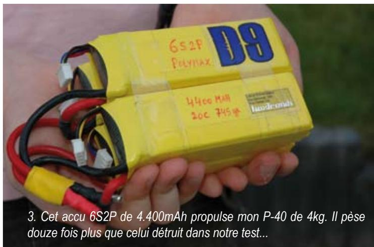
3. Cet accu 6S2P de 4.400mAh propulse mon P-40 de 4kg. Il pèse douze fois plus que celui détruit dans notre test...
