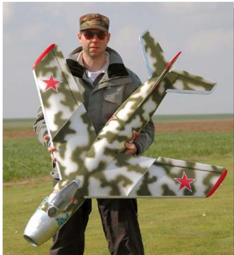
*Les turbines électriques ont un rendement médiocre à basse vitesse. N'espérez pas plus de 2gr de poussée par watt au décollage.*
