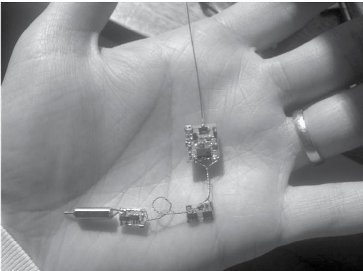
pour remplacer bon nombre de composants. Et donc pour fabriquer un récepteur aussi petit, j'ai remplacé des dizaines de composants par un microprocesseur ! Donc un gain de poids de place et de coût aussi... Dernière chose, les servos !
