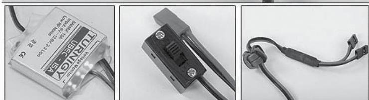
Cet UBEC fournit jusqu'à 15A en pointe sur base d'un lipo dédié de 2 ou 3 éléments. Idéal pour les planeurs ou les avions de voltige, même thermiques.
