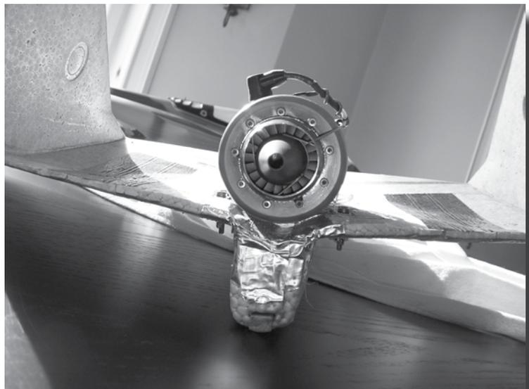
d'entraînement de la turbine par moteur électrique, pour un démarrage automatique et pour la refroidir après l'arrêt. Un autostart comme il dit. Plus besoin du sèche-cheveux. Donc, re-re-démontage de la turbine, et re-envoi à l'usine.
