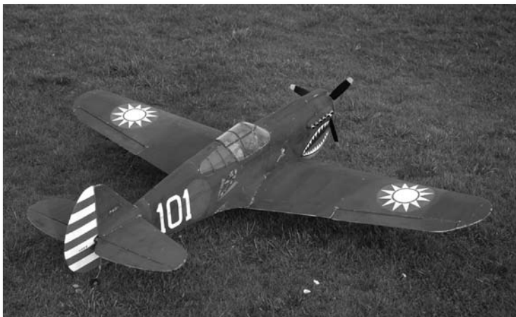
Cocardes et gueule de requin réalisés à l'aide de pochoirs: beaucoup plus simple qu'il n'y paraît!
