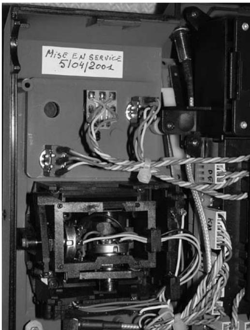
Le câble blindé de l'antenne 2.4 GHz passe le long du stick
