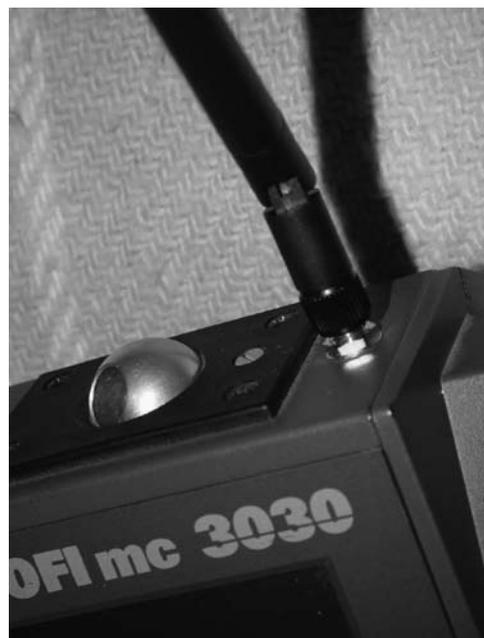
A côté du socket d'antenne original, la petite antenne 2.4 GHz
