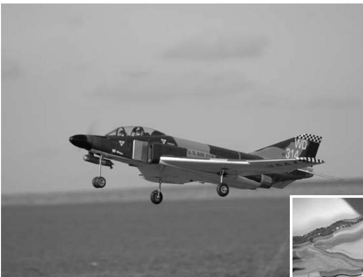
Les caméras embarquées supportent mal les vibrations des moteurs, surtout les thermiques. L'exemple en encadré illustre l'effet sur la vidéo
