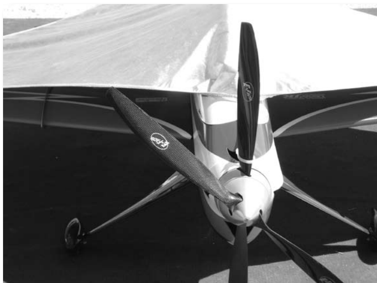
Hélices contra-rotatives sur l'avion de Silvestri
