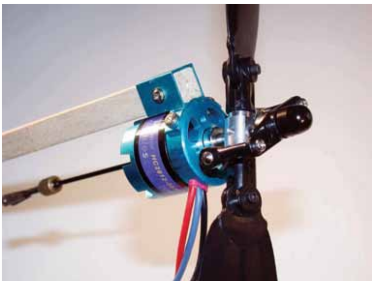
Les hélices à pas variable en vol permettent de freiner et même de voler en marche arrière, mais leur mécanique est fragile et leur rendement médiocre.
