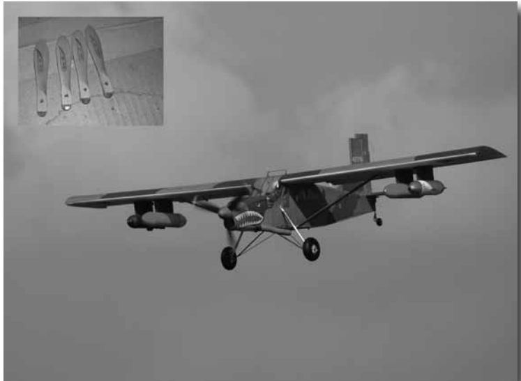
Les multipales ont un look d'enfer, mais en général leur rendement n'est pas fameux. En insert, un exemple d'hélices monopales, une curiosité populaire en vol circulaire.
