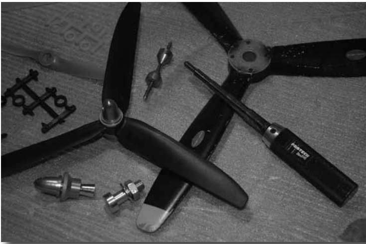
Un simple alésoir manuel est bien plus précis qu'une perceuse, même sur colonne. Un outil indispensable pour des hélices qui tournent rond.
