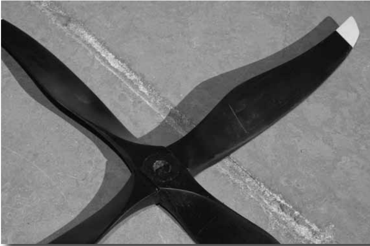
Quadripale faite de deux bipales en bois. Ce bricolage convient aux moteurs électriques qui génèrent moins de vibrations et tournent à un régime inférieur.
