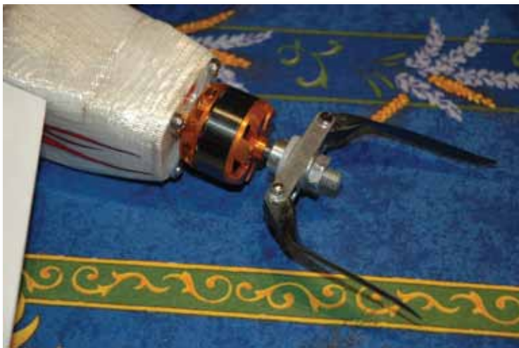
Les hélices repliables sont idéales pour les planeurs et les appareils se posant sur le ventre. Les pales pivotent librement, c'est l'effet centrifuge qui donne sa 'rigidité' à l'hélice.
