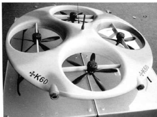
Le quadrirotor Kolibri de Rheinmetall, Allemagne (1.6 kg)
