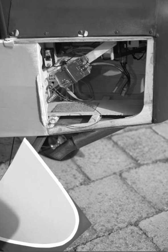
L'accu situé sous le brushless est accessible par ouverture du capot-moteur.
