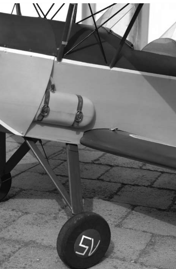
Le train n'étant pas suspendu, il vaut mieux opter pour des roues 'ballon'.
