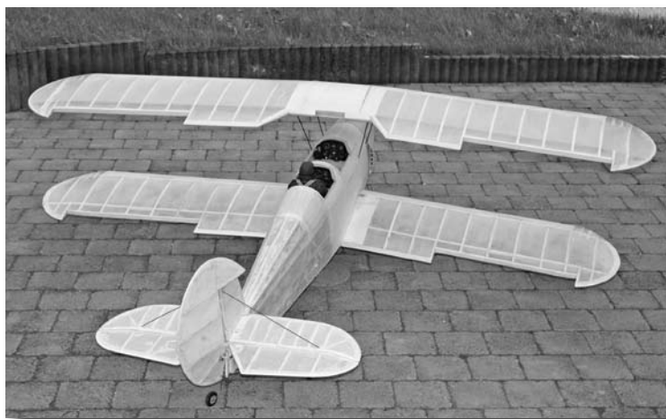
Entoilage à la soie, ultra-léger et bien dans l'esprit 'vieille toile'
