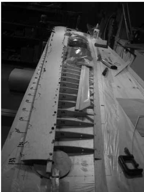
Coffrage du bord d'attaque en prenant soin de bien plaquer l'aile sur le plan de travail pour éviter qu'elle ne vrille (ici des sacs de riz de 1kg, ça fait masse et s'est souple)
