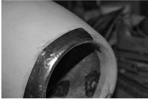
Pose de l'alu autocollant à la cuiller sur un gros jet en dépron: effet garanti!
