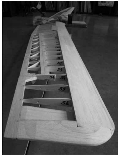
réaliser l'opération. Là on commence à se rendre compte que l'oiseau sera imposant. Cette étape est importante pour régler le positionnement des ailes sur le fuselage et caler le fourreau de clés d'ailes dans la bonne position.
