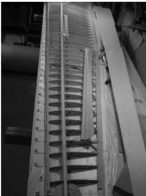
Le bord d'attaque est collé, balsa et pin; également vers l'implanture, la réservation pour l'aérofrein.
