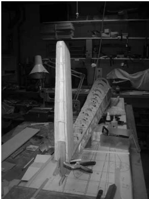
L'ensemble monté à « blanc » sur le fuselage.
