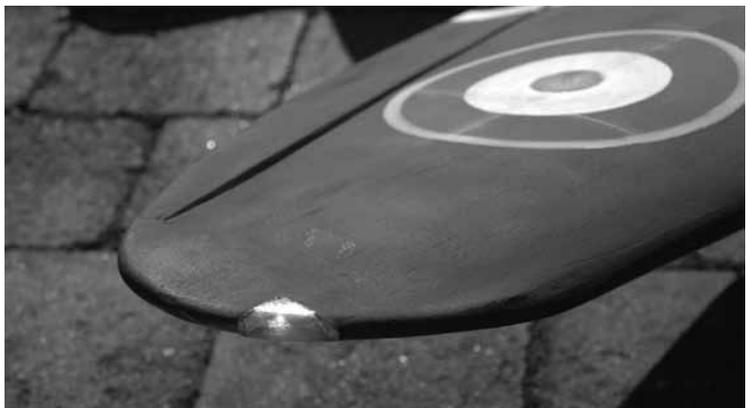
Gros plan sur le feu de position (LED 120°). De près, on remarque les fibres de bois sous le bouche-pores.
