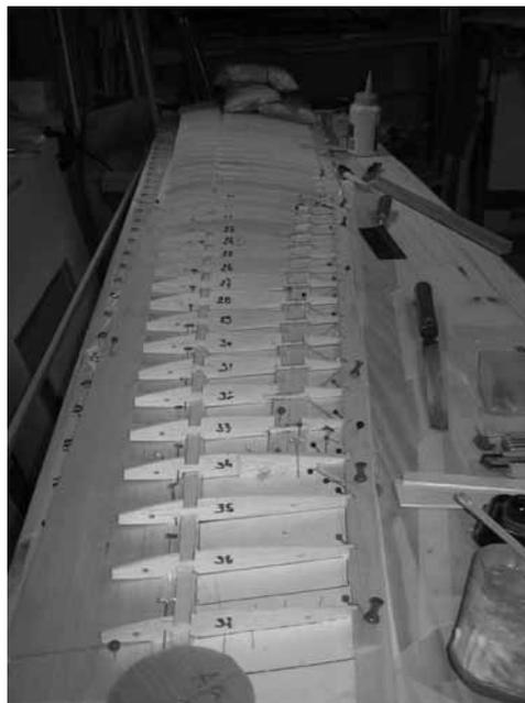
Voilà l'ossature se met en place, bord de fuite, structure de l'aileron, ....
