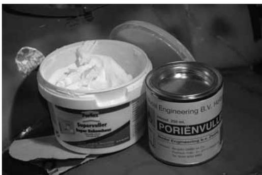
L'enduit de rebouchage ultraléger est facile à identifier en grande surface: quand on soulève le pot il semble vide! Passez une couche de bouche-pores nitrocellulosique (à droite) avant finition.
