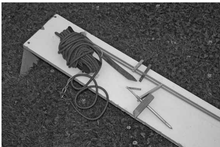
La catapulte posée sur le tremplin: élastique, ficelle, piquet, pédale de déclenchement, baguette.
