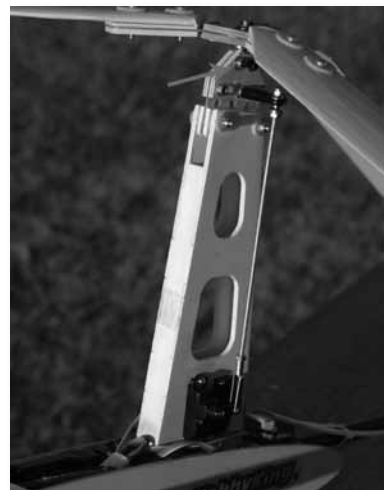
La fixation du rotor a été renforcée (flèche) suite au crash du premier exemplaire.
