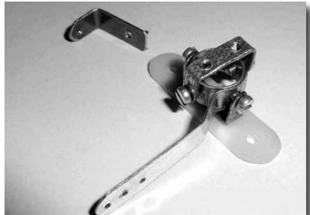
au moteur qui recevra également la fixation de la boule de la chape de commande du deuxième axe. Ces pièces sont faites en plaque époxy de 1 mm ou contreplaqué de 1,5 et fixées aux étriers avec des vis M2 à pan oblique.
