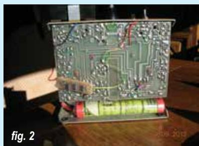
Avant de fixer le circuit imprimé, reconnecter le fil noir au voltmètre et faites passer les fils du module et de l'interrupteur au dessus du circuit afin de pouvoir les souder à la platine. Fixez la platine et reconnectez le conducteur entre l'antenne 72 Mhz et la platine.
