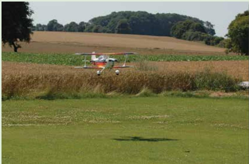
*Approche dans l'axe de piste, le pilote maintient les ailes à plat aux ailerons et contrôle la descente au moteur.*
