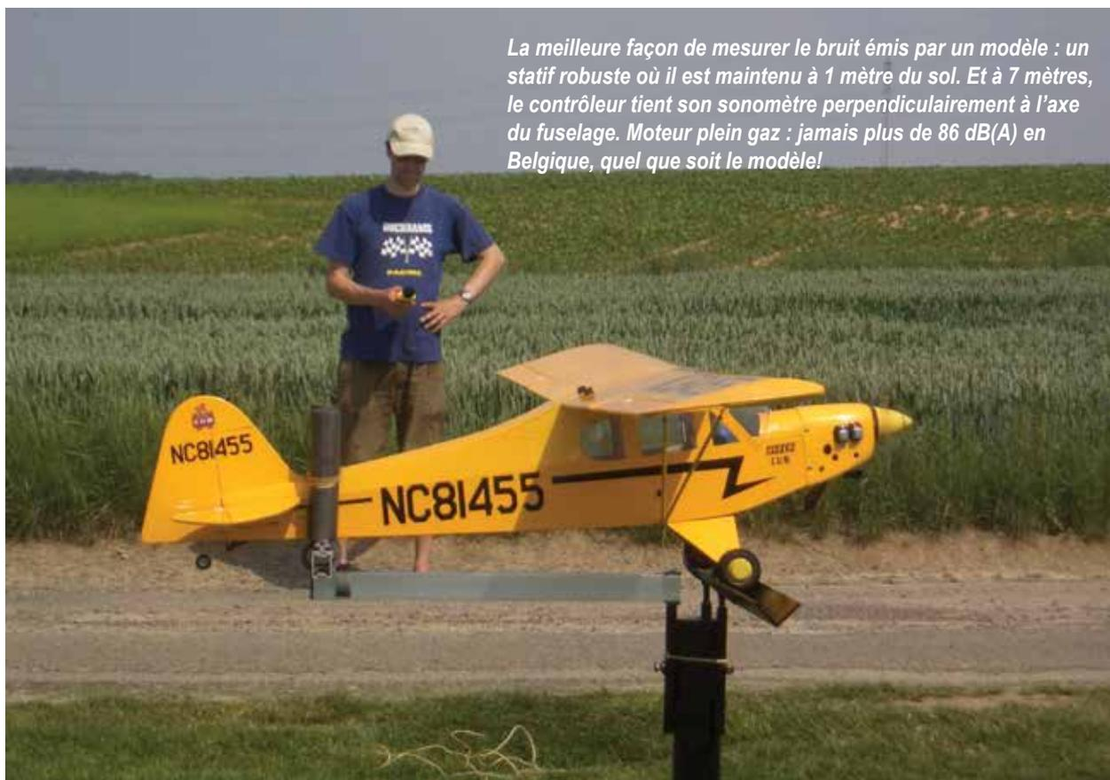
*La meilleure façon de mesurer le bruit émis par un modèle : un statif robuste où il est maintenu à 1 mètre du sol. Et à 7 mètres, le contrôleur tient son sonomètre perpendiculairement à l'axe du fuselage. Moteur plein gaz : jamais plus de 86 dB(A) en Belgique, quel que soit le modèle!*
