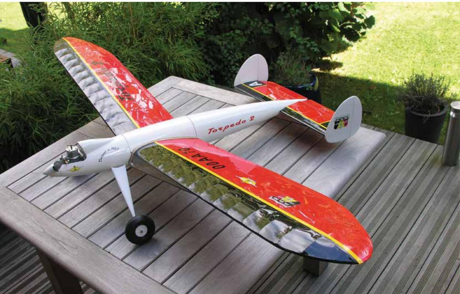
donc à regarder les photos, mais rien de spécial n'est à déclarer si ce n'est qu'il faut penser à placer une cale de 6 mm en dessous de la dernière nervure, au niveau du bord de fuite, afin de ménager un peu de wash-out (torsion du bout d'aile, ce « truc » aide à la stabilité du modèle).
