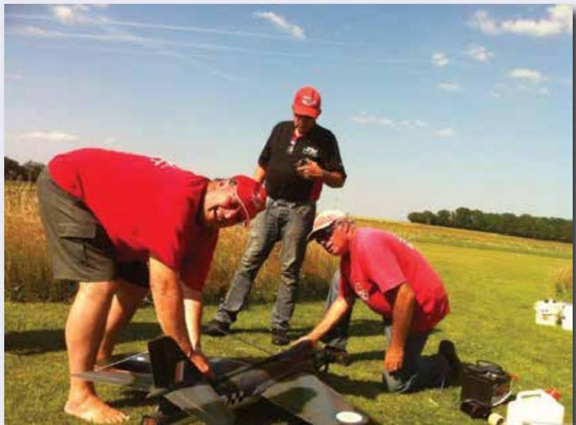
D'autres sont également venus avec leur modèle. Pol a reconstruit un «Radio Queen». Moteur électrique, envergure 2 m, entoilage des ailes à l'Oracover, le fuselage à la soie, le stabilo au papier. Les charnières sont cousues main. Un vol impeccable rien que pour moi.
