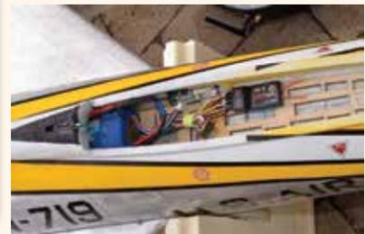
L'accu doit être positionné fort en arrière ; il peut être nécessaire d'agrandir son logement. Notez qu'il n'y a pas de tout de ventilation, un bon accu est donc indispensable.
