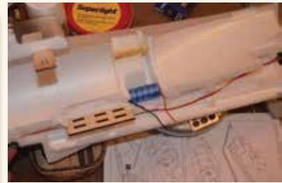
L'emplacement du gros condensateur électrolytique, sous la turbine.
