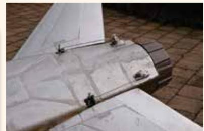
Les servos repositionnés sous le fuselage. Grâce aux bidons ils ne touchent pas le sol.
