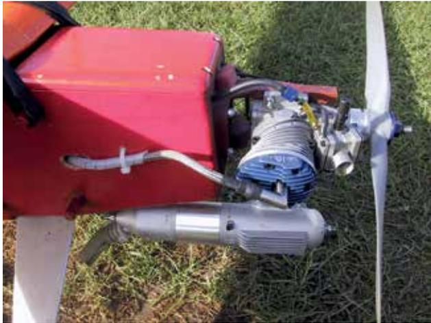
est sensible aux vibrations : il faut prendre les précautions d'usage recommandées par le fabricant. La connexion du câble haute tension à la bougie est très astucieuse (voir mode d'emploi).
