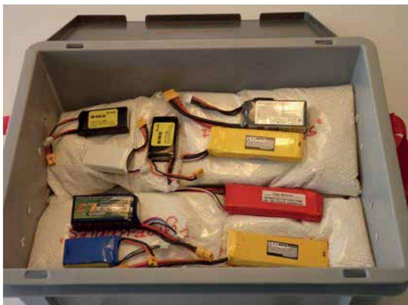
de prévoir tout alentour de chaque batterie un espace d'au moins 4 cm de granules. Avec ces sachets, il est aisé de réaliser un emballage de plusieurs packs de batteries dans un LionGuard de type XS 1 qui fait extérieurement 40 x 30 x 23,5 cm.
