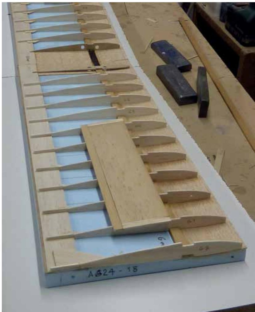
de l'imprimante, impression de profils générés par Profili. Au passage, c'est un programme que je recommande. Je découpe alors au plus près à la sauteuse et puis j'ajuste en ponçant soigneusement à la ponceuse rotative de ma Dremel, puis j'ajuste les passages de longeron.
