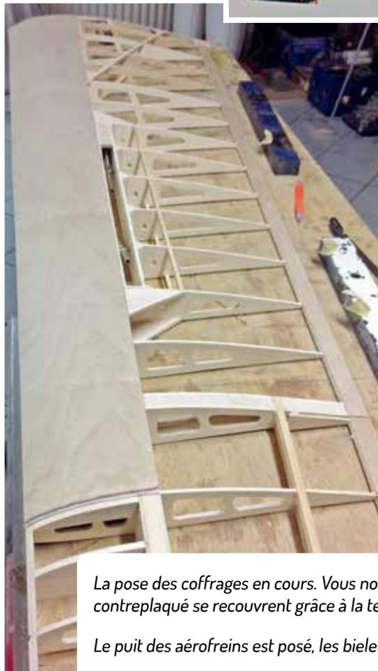
La pose des coffrages en cours. Vous noterez que les jointures des panneaux de contreplaqué se recouvrent grâce à la technique de l'enture.
