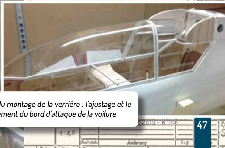
Le point le plus compliqué du montage de la verrière : l'ajustage et le positionnement du prolongement du bord d'attaque de la voilure
