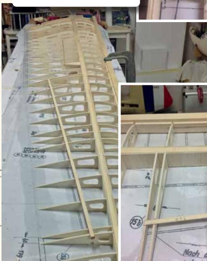
Le doublage de la nervure aux extrémités de l'aileron et le longeron arrière matérialisant son emplacement.
