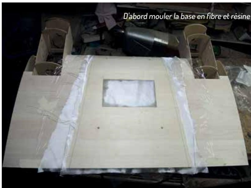
*D'abord mouler la base en fibre et résine*
