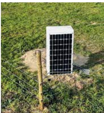
Le panneau solaire choisi est un modèle 100 W sur support souple, destiné au montage sur véhicules. Nous l'avons monté verticalement, et bien entendu exposé plein sud. Comme au creux de l'hiver, notre soleil ne monte pas à plus de 15 degrés au-dessus de l'horizon, la position verticale du panneau est en réalité très proche de l'optimale.
