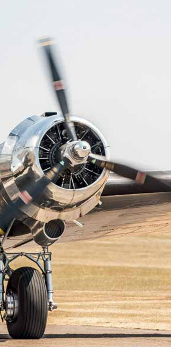
types de terrains, même non préparés. Une jambe amortie de chaque côté de la roue et un grand bras vers l'arrière forment un triangle «béton». Qualité qui va nous être bien utile sur le modèle réduit.
