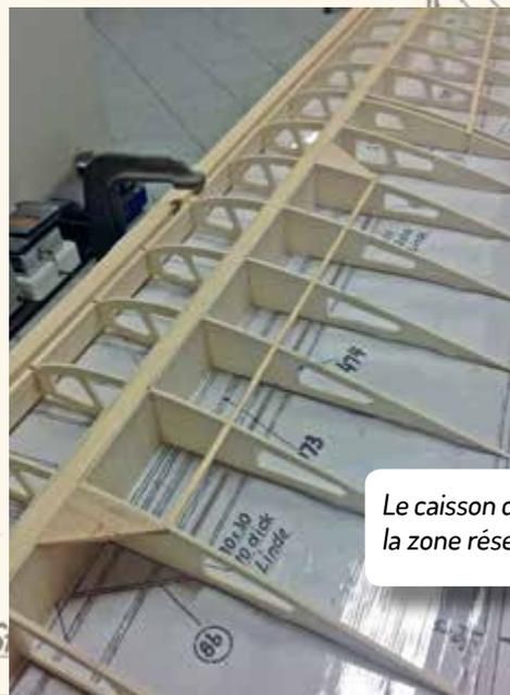
Le caisson du longeron formé par des âmes en balsa et la zone réservée au puits des aérofreins.
