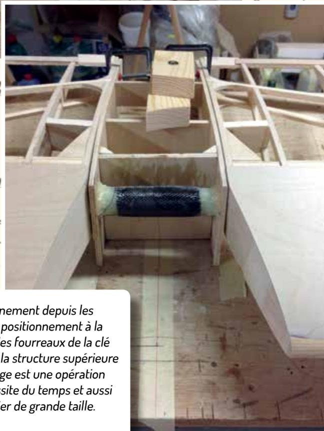
Le cheminement depuis les essais de positionnement à la fixation des fourreaux de la clé d'aile sur la structure supérieure du fuselage est une opération qui nécessite du temps et aussi un chantier de grande taille.
