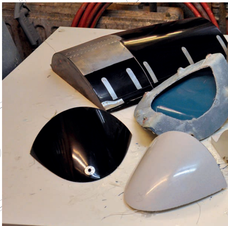
Démoulage d'une des poutres de queue
