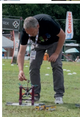
Avant chaque course, contrôle de la puissance d'émission vidéo et de la tension de la batterie de propulsion.
