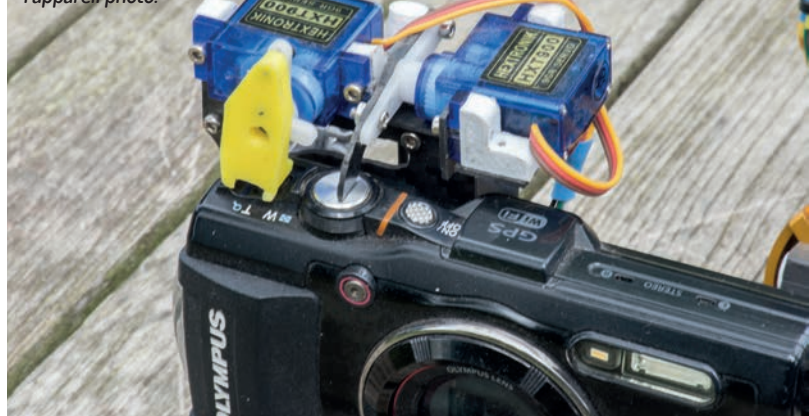
Mécanisme de commande du déclenchement et du zoom de l'appareil photo.
