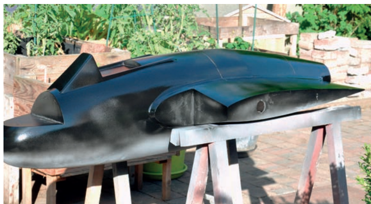
Pose de la peinture après chaque cycle surfacage, jusqu'à obtention d'un résultat parfait.
