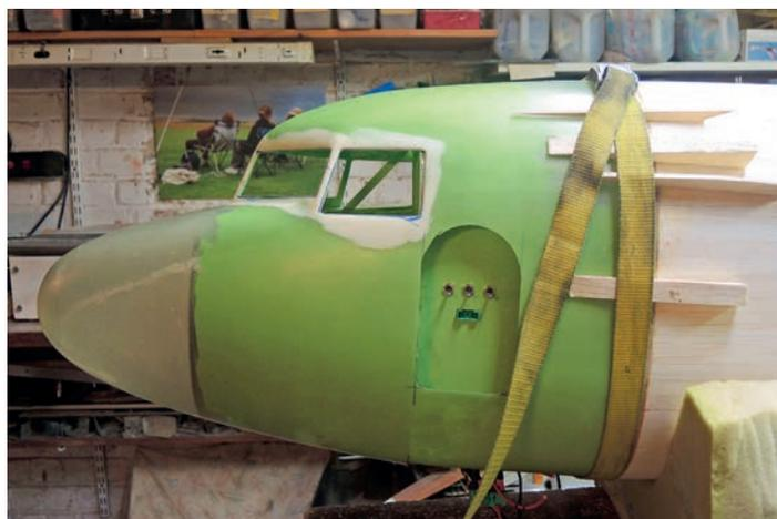
Une phase délicate, la jonction du cockpit en fibre avec la structure en bois
