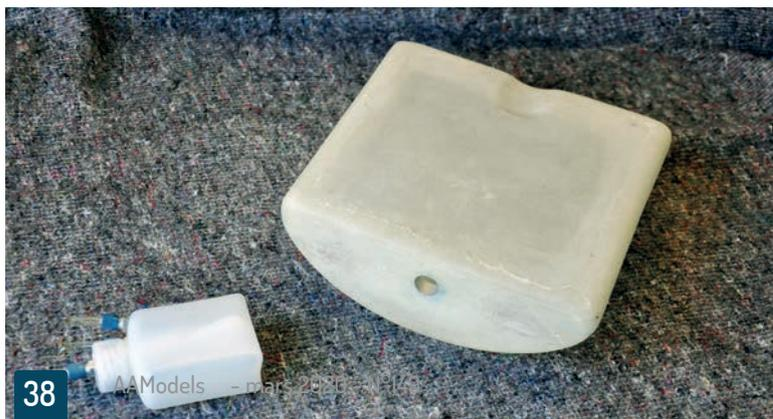
Le réservoir en fibre de verre/époxy, à l'avant la nourrice qui sert à "débuller" le carburant.
