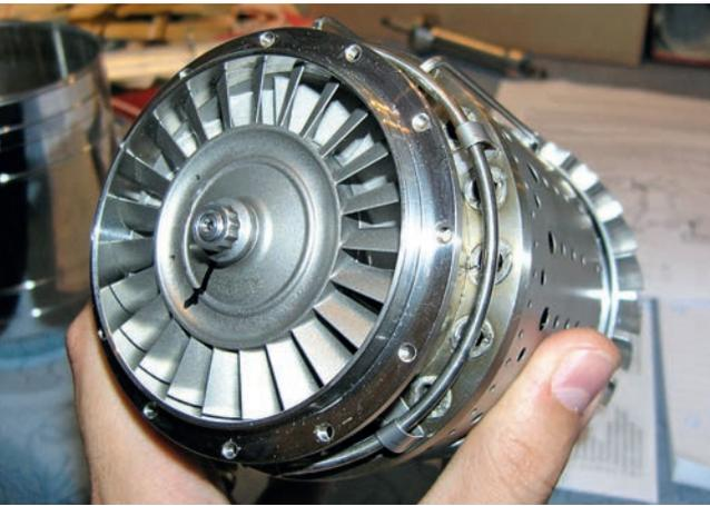
La roue à aube est la turbine. Elle est fixée sur l'arbre formant l'attelage "compresseur/turbine". Derrière celle-ci, vous pouvez distinguer le distributeur. Le carter enserrant la turbine est solidaire du distributeur et sert aussi à la fixation de l'échappement.
