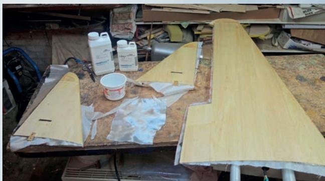
Recouvrement de la voilure et des empennages par un fin tissu de verre
