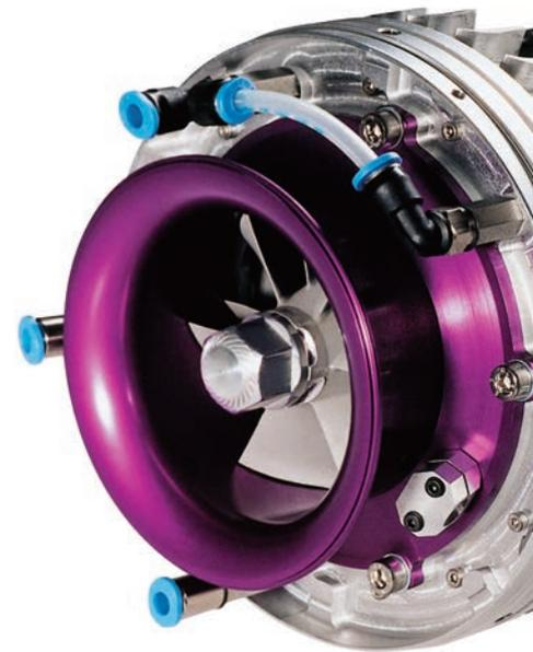
A droite, l'ensemble rouet et diffuseurs. Juste derrière, la chambre de combustion avec tout à l'avant une première série de trous alimentant en air la zone de combustion. A cet endroit se situe l'embouchure des tubes brûleurs.
