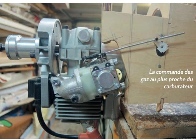
La commande des gaz au plus proche du carburateur
