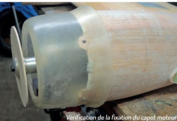
Vérification de la fixation du capot moteur
