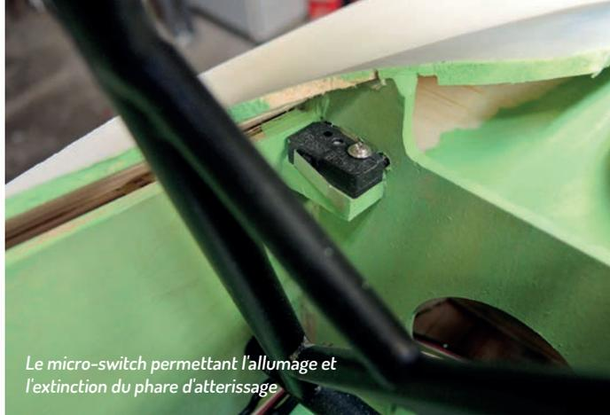
Le micro-switch permettant l'allumage et l'extinction du phare d'atterrissage
