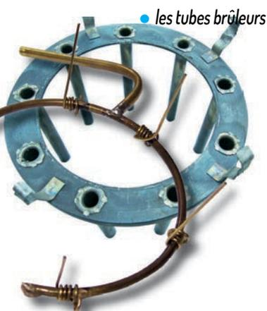
• La tubulure d'amenée du carburant et les "injecteurs"
