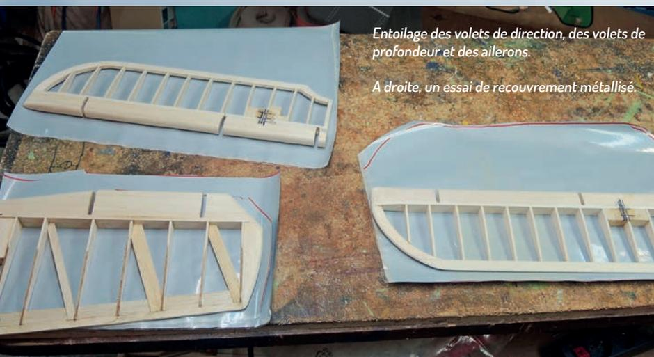
Entoilage des volets de direction, des volets de profondeur et des ailerons.
