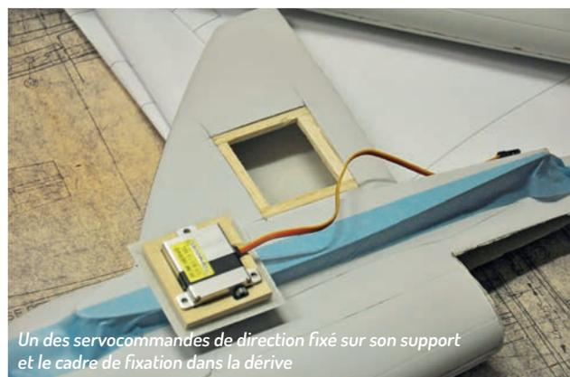
Un des servocommandes de direction fixé sur son support et le cadre de fixation dans la dérive
