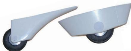
Des prises d'air type NACA constituent aussi une solution bien élégante. Mais les ouvertures sous le fuselage possèdent un inconvénient : comme le planeur va rouler sur le sol, des débris d'herbes coupées et autres déchets indésirables peuvent facilement être ingérés.
