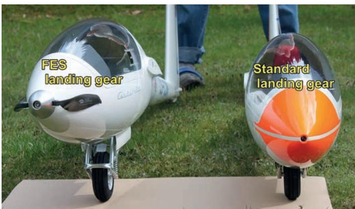
L'atterrisseur rétractable rehaussé destiné à garantir à l'hélice une garde au sol suffisante
