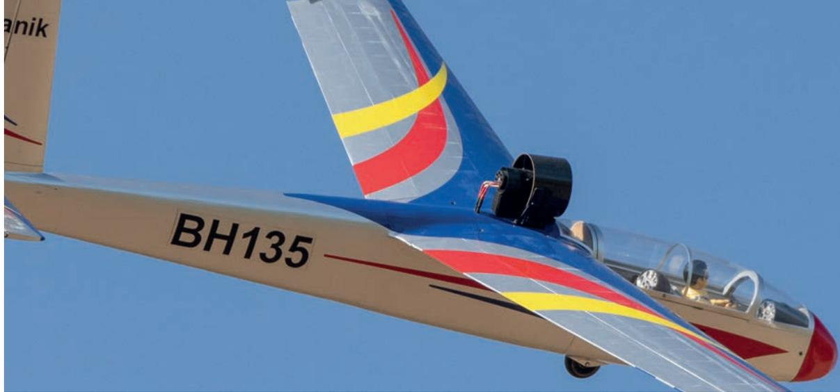
Une turbine électrique en pylône fixe dans le cas de ce Blanick
