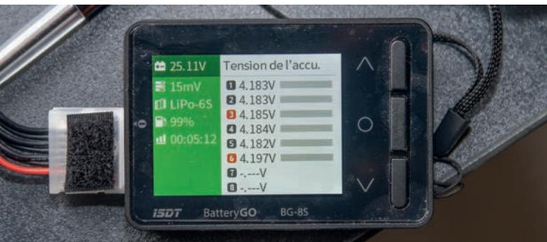
Une séquence d'équilibrage en cours d'activité, les chiffres en rouge identifient les cellules dont la tension est amenée progressivement vers le niveau le plus bas
