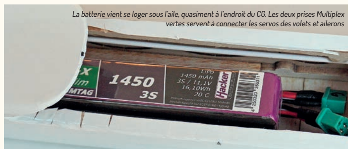
La batterie, une LiPo 3S/1450mAh « Slim » est mise en place par l'avant, sans nécessiter de démontage de l'aile
