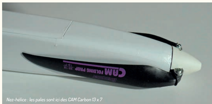
Nez-hélice : les pales sont ici des CAM Carbon 13 x 7
