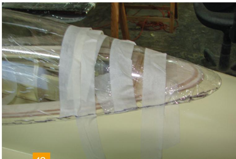
En cas de collage seul, il convient de surveiller que la verrière ne se déforme pas sous la tension des bandes adhésives utilisées durant la prise de la colle.
