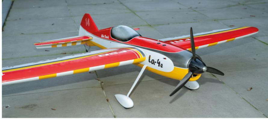
Au-dessus, le Leonidov - La 4<sup>e</sup>, conçu par Alexander Leonidov (Ukraine), d'une envergure de 1,55 m et équipé d'une motorisation électrique (moteur BadAss 3515-710 Kv).
