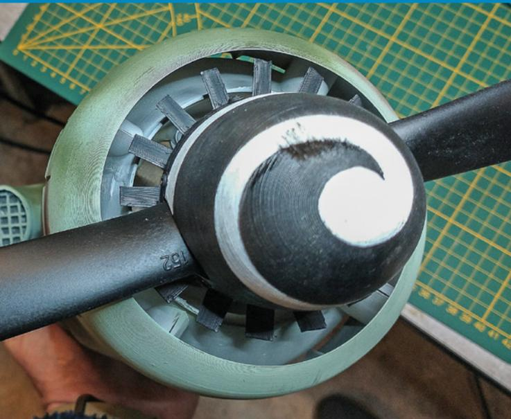
Comme sur le petit Ta-152H, une turbine fixée derrière le cône assure un excellent refroidissement tout en participant à la traction.
