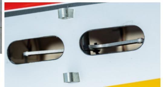
En haut, le profil particulièrement épais des modèles de voltige. Sur la même vue, les attaches en corde à piano, semblables à des goupilles bêta, se fixent au palonnier.
