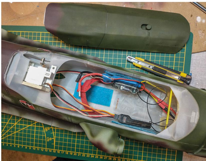
Au-dessus, la gouverne de direction est démontable en retirant son axe (une tige en carbone). Notez aussi la commande de roulette, simple et efficace.
