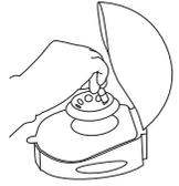
Ouvrir la pochette de conditionnement, puis centrifuger le tube de **standard moléculaire** synthétique **Helix Elite™** avant d'ouvrir le tube afin d'éviter toute perte de matériau séché.
